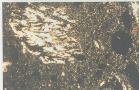
Fig. 30. Particolare della tessitura gessosa microcristallina del campione di malta di gesso (FOR 13) addizionata di resina isotropa consolidante, al cui interno sono presenti noduli policristallini gessosi (al centro della micrografia), inerti quarzosi, carbonatici. Particelle di cenere sono inoltre visibili nel lato destro della micrografia (N//, 150X).
