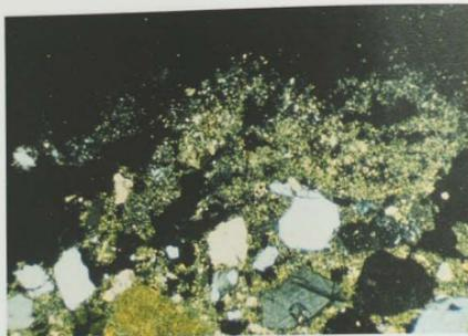
Fig. 85. Sezione sottile trasversale del campione (ARC 3) prelevato nella parte inferiore ricostruita della decorazione. Il campione è costituito di malta a matrice gessoso-carbonatica e da inerti ad elevata varietà composizionale: quarzoso-feldspatica, calcitica, micaea. Nella parte superiore della micrografia è possibile osservare la superficie esterna del campione: la matrice gessoso-carbonatica microcristallina, priva di inerti, risulta fortemente decoesa (N#, 40X).
