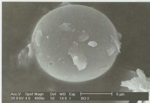
Fig. 8. Micrografia SEM relativa a particelle lisce allumosilicatiche, parzialmente coperte da microcristalli di soil dust (a composizione prevalentemente silicatica e carbonatica), emesse in atmosfera da centrali termoelettriche a carbone. Generalmente sono trasparenti, con colorazioni variabili fra il bruno, il rosso ed il verde pallido.
