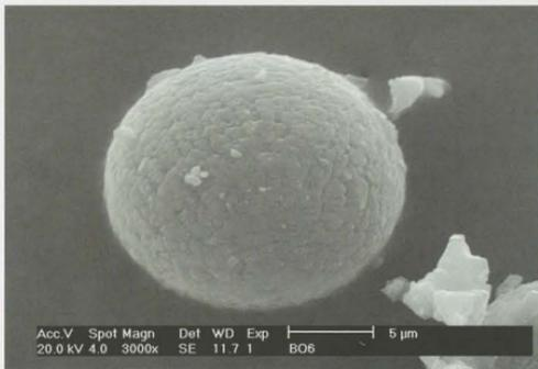
Fig. 9. Micrografie SEM relative a particelle metalliche, dall'aspetto rugoso e composte principalmente da ferro. Vengono emesse in atmosfera da centrali ad olio o carbone.
