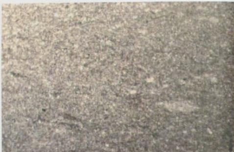
Fig. 38. Micrografia del campione FOR 30 in cui è possibile osservare la grana minuta, la tessitura leggermente scistosa e la compattezza, caratteristiche del campione stesso (N //, 40X).
