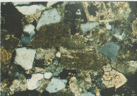
Fig. 24. Particolare di un campione di calcarenite (FOR 9) nel quale sono evidenti i trattamenti pregressi di pulitura subiti dal materiale. I grossi cristalli di carbonato di calcio (al centro della micrografia) risultano alterati da un fine graticcio che ne oblitera le caratteristiche morfologiche superficiali originarie (N#, 150X).
