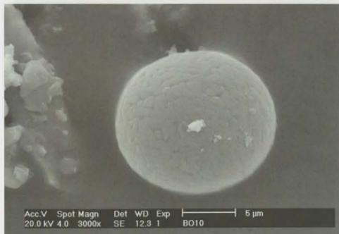
Fig. 70. Micrografie SEM dell'aerosol depositato sulle superfici lapidee del monumento. È stata rilevata una particella carboniosa (in alto) ed una particella metallica (in basso) depositatesi sulla superficie del materiale.
