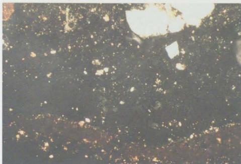
Fig. 41. Campione di malta di calce (FOR 22) in cui è possibile osservare la matrice carbonatica micritica che ingloba inerti carbonatici e silicatici (N#, 150X).
