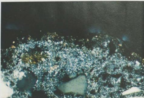
Fig. 22. Particolare della matrice carbonatica di un campione calcarenitico (FOR 2), completamente trasformata in gesso microcristallino per effetto del processo di solfatazione (N#, 150X).
