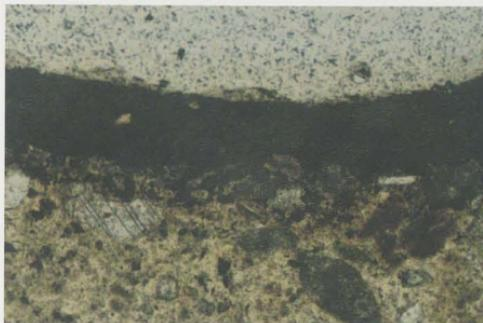
Fig. 4. Esempio di malta di calce con presenza di pellicola pittorica superficiale.
