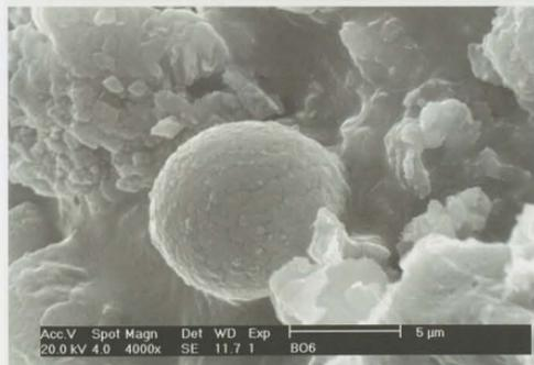
Fig. 57. Micrografie SEM relative al campione PIO IV\_1 in cui è possibile osservare una particella carboniosa (in alto) ed una particella metallica (in basso) depositatesi sulla superficie del materiale.
