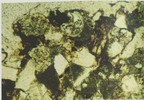
Fig. 90. Particolare della calcarenite a cemento carbonatico e argilloso del campione ARC2; fra gli inerti è riconoscibile un guscio calcitico di organismo marino al centro in alto della micrografia. Sono inoltre presenti (parte bassa della foto) tracce di trattamenti di pulitura sui granuli carbonatici (N#, 150X).
